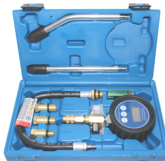
BGS8980 Digitale compressiemeter benzine Compressiomètre essence M10x1.0-M12x1.25-M14x1.25-M18x1.5 150 €
