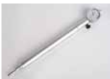
Outil de positionnement pour point mort haut P3462-115
