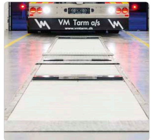
Solution châssis Châssis fourni séparément, colonnes de levage et circuits installés en rattrapage
