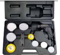
1 ponceuse pistolet RC7682 / Diamètre de l'excentration : 5 mm / Vitesse à vide : 15000 tr/min / Longueur : 125 mm / Poids : 0,5 kg
