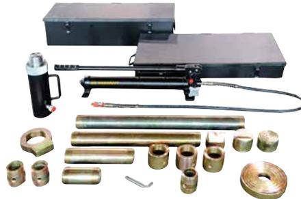
Lot de vérins hydrauliques 20 t (20 pièces). Pompe manuelle à deux crans pour une pression de travail de 700 bars. Comprend un jeu complet d'accessoires (en acier avec les extrémités filetées).
