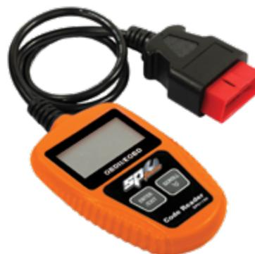
LIRE ET EFFACER LES CODES D'ANOMALIE DE DIAGNOSTIC (DTC) ET ÉTEINDRE LE TÉMOIN DE PANNE MOTEUR OU D'AIRBAG.
