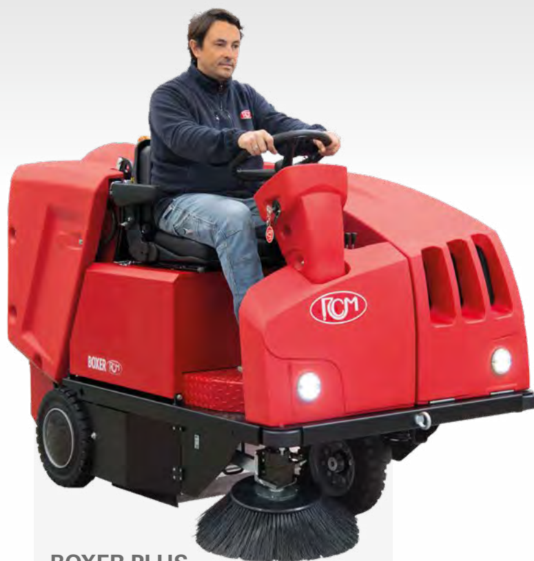
BOXER PLUS balayeuse avec aspiration et traction
