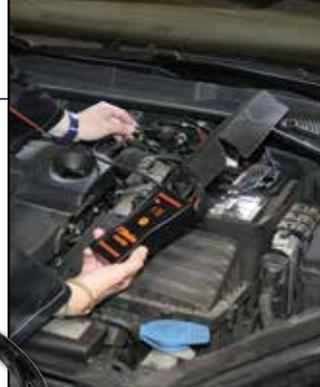
Pour effectuer le diagnostic individuel des composants de l'installation électrique, il suffit d'approcher la sonde du composant en question.
